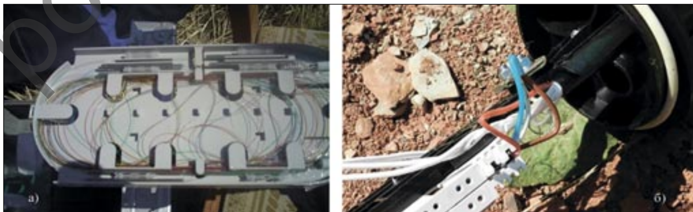
Рис. 1. Последствия выдавливания в муфту оптических волокон (а) и модулей (б)
